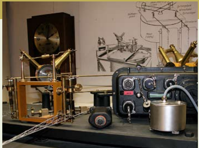
▲ Alt und neu im Geophysikalischen Observatorium der LMU: Ein moderner, kompakter Seismograph auf dem über 100 Jahre alten Wiechert'schen Horizontalseismograph.
